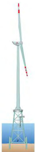
la fondation choisie pour les turbines et la sous-station électrique sera du type « jacket », c'est-à-dire en treillis tubulaire. (source Iberdrola)
