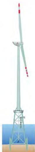
la fondation choisie pour les turbines et la sous-station électrique sera du type « jacked », c'est-à-dire en treillis tubulaire. (source Iberdrola)
